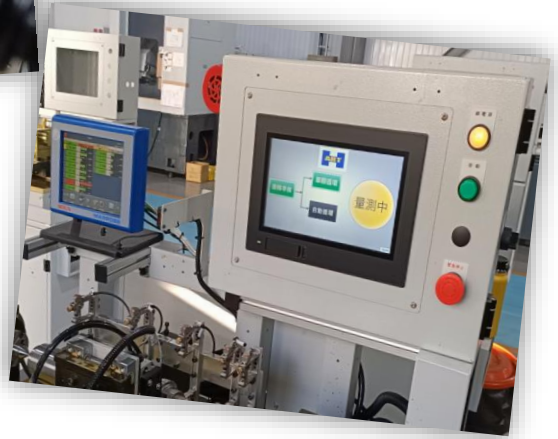
【智能車床量測補償系統及其設定螢幕】
